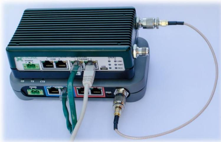
Nota: por lo menos los radios Maestro deben ser inspeccionados en busca de energía reflejada. XetaWave recomienda una potencia reflejada  $\leq 10\%$  de su potencia Fwd.
