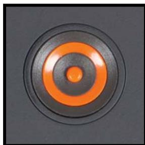
Para encender el sistema junto con el monitor, presione el botón de alimentación naranja que se encuentra al lado de la rueda del zoom en el panel de control. El ClearView C se encenderá en el mismo modo de visualización en el que se apagó.
