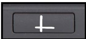
Durch das Drücken der Hilfslinien/Bildschirmabdeckung-Taste (zweite Taste von links) wechseln Sie den Modus zwischen Linieneinblendung, Bildschirmabdeckung oder der Vollbilddarstellung nacheinander. Die Hilfslinien können Ihnen das Lesen von Texten oder das Schreiben auf der Vorlage erleichtern. Die Bildschirmabdeckung kann benutzt werden wenn Sie die großflächige Helligkeit des Bildschirms stört oder Sie sich nur auf ein bis zwei Textzeilen konzentrieren möchten.
