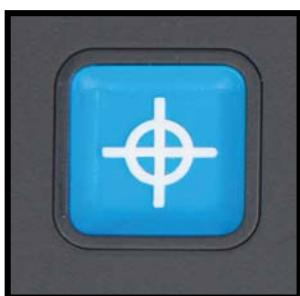
青い正方形のワイド表示ボタンを3秒間押すと、カメラの真下の位置が、赤いスポットライトで照らされます。カメラが写している位置を特定するのに役立ちます。例えば、書くとき、赤のスポットライトにペンを置くと、ペンが画面の中央に表示されます。もう一度このボタンを押すと、スポットライトが消えます。または、操作をしなくとも30秒後に自動的に、スポットライトが消えます。
