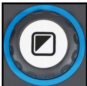
コントローラーの中央のズームダイヤルを時計回りに回すと倍率が上がり、反時計回りに回すと倍率が下がります。
