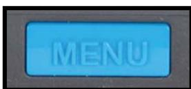
Druk op de menu knop, de middelste knop op het geavanceerde deel van het bedieningspaneel. Sluit het menu door nogmaals op deze knop te drukken. De menu items en keuzes zijn Engelstalig.
