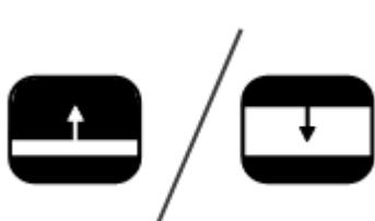
Drücken Sie bei eingeschalteten Hilfslinien oder Abdeckungen die graue Linien/Abdeckungen-Taste für 3 Sekunden. Die obere oder linke Hilfslinie oder Abdeckung blinkt um anzuzeigen, dass sie verschoben werden kann. Benutzen Sie das Vergrößerungs-Drehrad um die Hilfslinie oder Abdeckung zu bewegen.
