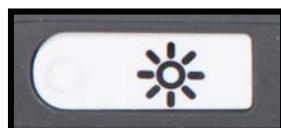
Falls Buchstaben oder andere Bildelemente nicht ganz klar dargestellt werden, benutzen Sie diese Funktion um das Bild zu verbessern und die Bildschärfe zu erhöhen. Zum Einstellen drücken Sie die weiße Taste mit dem fühlbaren Punkt und dem Sonnen-Symbol (ganz linke Taste). Mit dem Vergrößerungsregler stellen Sie nun die Bildqualität ein. Drehen Sie diesen nicht innerhalb von drei Sekunden so wird er wieder zum Vergrößerungsregler.
