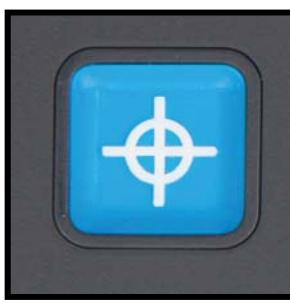
Premendo il pulsante quadrato blu per tre secondi si attiva un puntatore rosso a LED sul piano di lettura. Il puntatore consente di individuare il punto dove la telecamera sta puntando. Quando si scrive, se si posiziona ad esempio una penna sull'indicatore luminoso rosso, si vedrà la penna visualizzata al centro dello schermo. Premere ancora una volta il pulsante per spegnere la luce a LED. Dopo 30 secondi, il puntatore verrà automaticamente disattivato.
