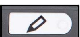
ClearView C 配备有自动对焦的摄像头，能确保屏幕上的图像始终清晰。当打开 ClearView C 的电源时，系统会进入自动对焦模式。按下带有铅笔标识的（最右面按键）自动对焦按键，ClearView C 会停止其持续运行的自动对焦模式，固定对焦在被浏览的目标物体上。当在写作、绘画或手工作品时，这个功能很有用。当自动对焦功能被关闭时，铅笔的标识就会出现在屏幕上。要激活自动对焦，仅仅需要再次按下自动对焦按键，那个标识就会消失，这说明自动对焦再次启用。
