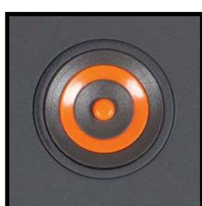
電源を入れるときは、コントローラーの真ん中の大きなズームダイヤルのとなりのオレンジ色の丸い電源ボタンを押してください。本体とモニターの両方の電源が入ります。そして前回電源を切ったときと同じ状態で立ち上がります。カメラが映像を写し始めるまでのセットアップに、約5秒から12秒かかります。
