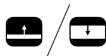
当激活标记线/标记窗功能时，按下灰色的标记线/标记窗按键三秒钟时间。标记线/标记窗的上方或左方闪烁，说明可以先向上、下、左或右方向移动。使用放大旋钮来移动标记线/标记窗。按下标记线/标记窗按键调节标记线/标记窗的另一面。同样使用放大旋钮来移动标记线/标记窗的另一侧。再次按下标记线/标记窗按键退出该模式。
